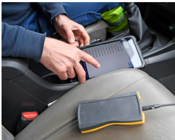
Einmal jährlich wird das Gemeindegebiet abgefahren, um die Wasseruhren abzulesen.
